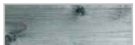
Unbehandelte Oberfläche Folge: Holz vergraut vollflächig
